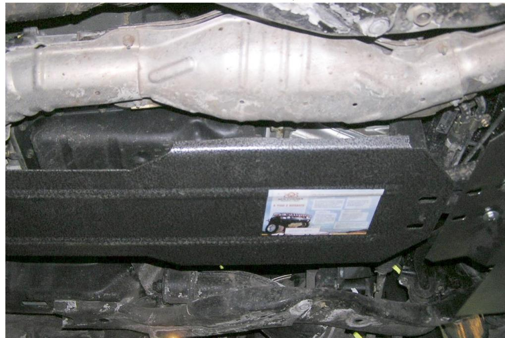
1. Открутить 2 штатных болта на поперечном усилителе лонжеронов.
