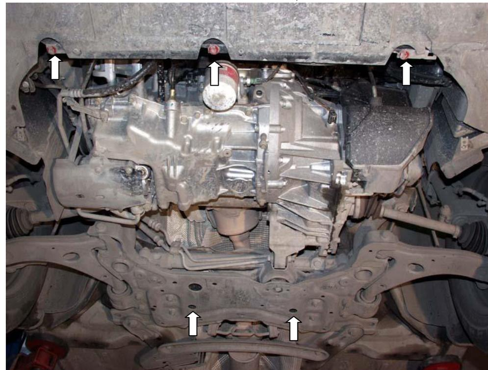
1. Снять штатную пластиковую защиту.
