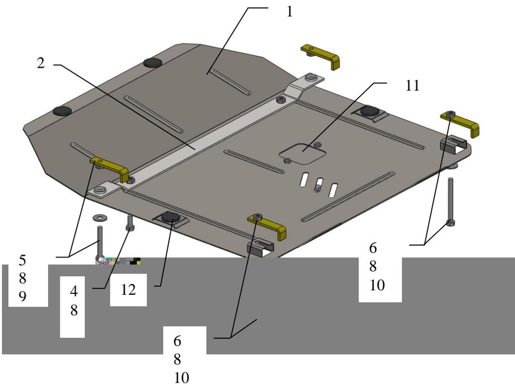
1. Закрепить балку 2 в передние сквозные отверстия балки двигателя болтами 5 с помощью закладных пластин 9, рис.1.
