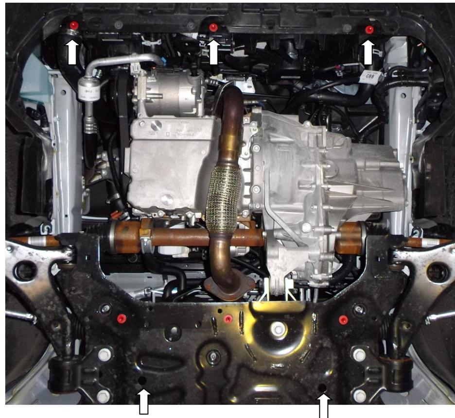
1. Снять штатный пыльник.
