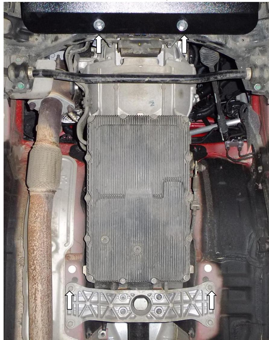
1. Ослабить 2 задних болта защиты двигателя и 2 болта балки КПП, рис.1.
