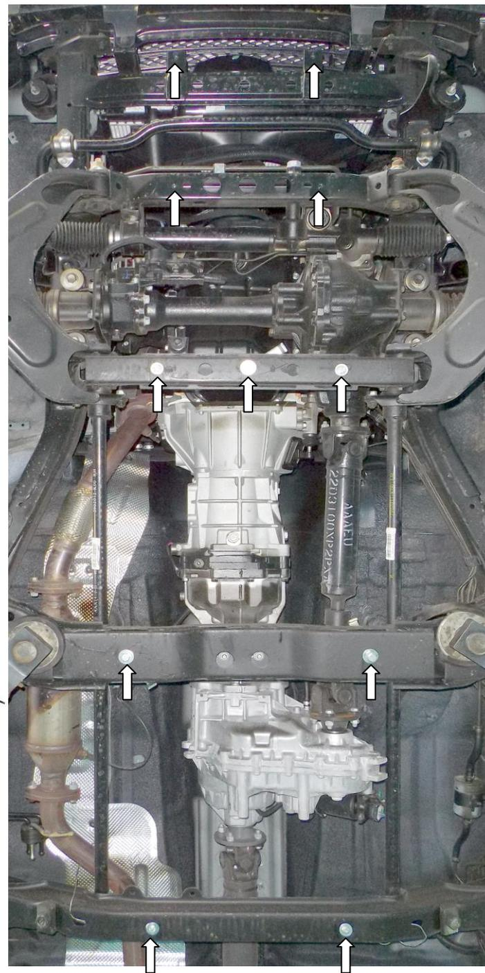
**ВНИМАНИЕ!!!** После монтажа защиты не допускается соприкосновение элементов защиты с движущимися элементами узлов и агрегатов автомобиля.
