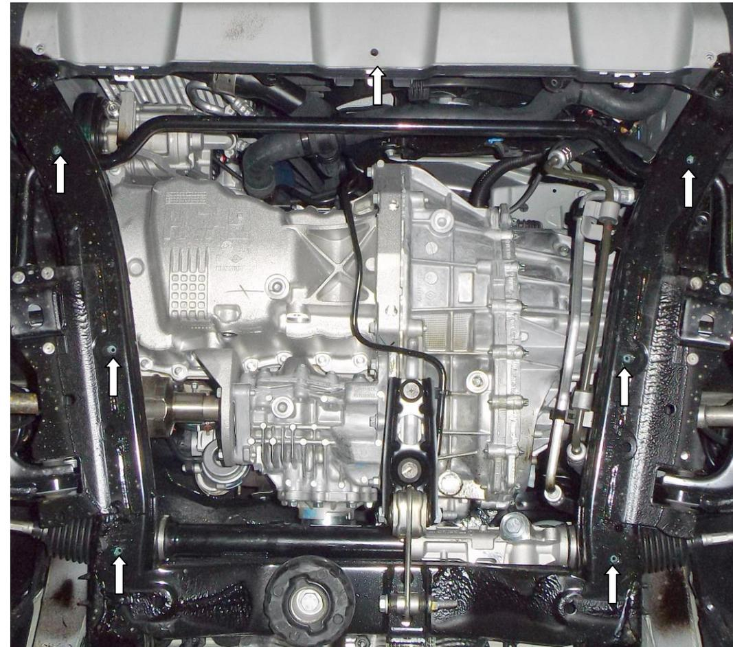
1. Установить панель 1 в штатные гайки подрамника автомобиля болтами 2.
