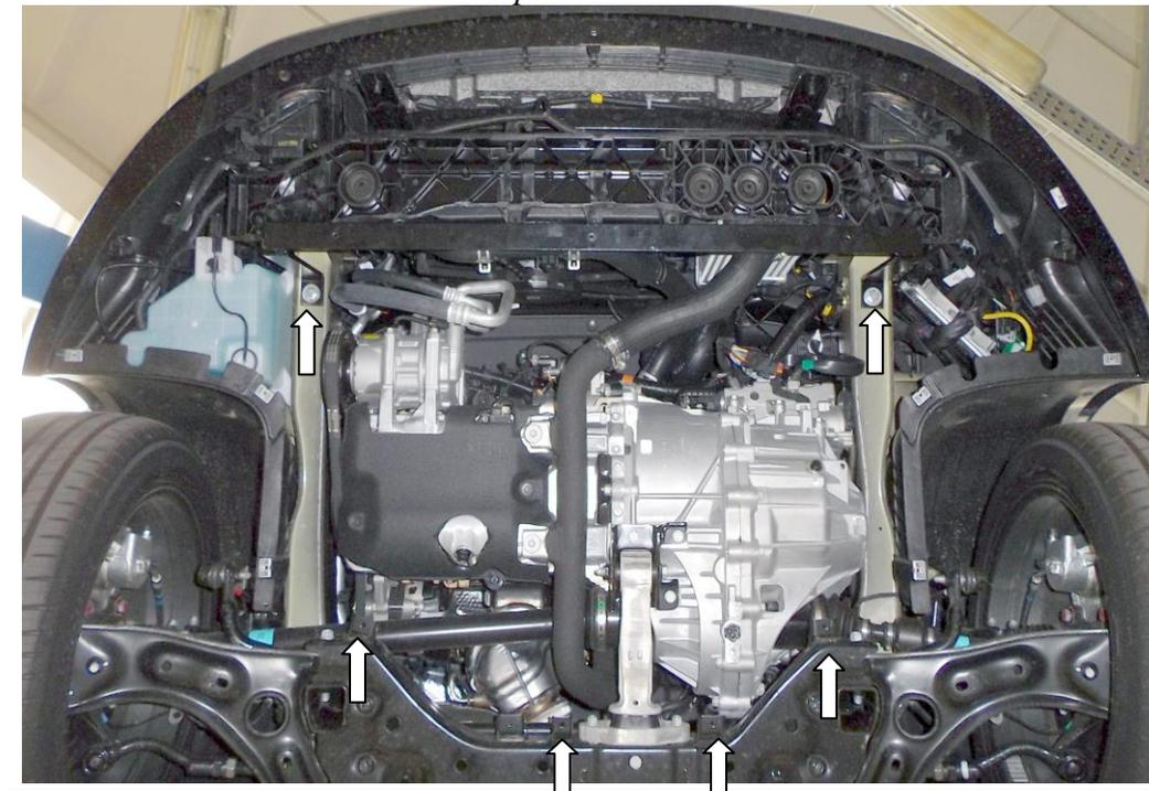
1. Снять штатный пластиковый пыльник.
