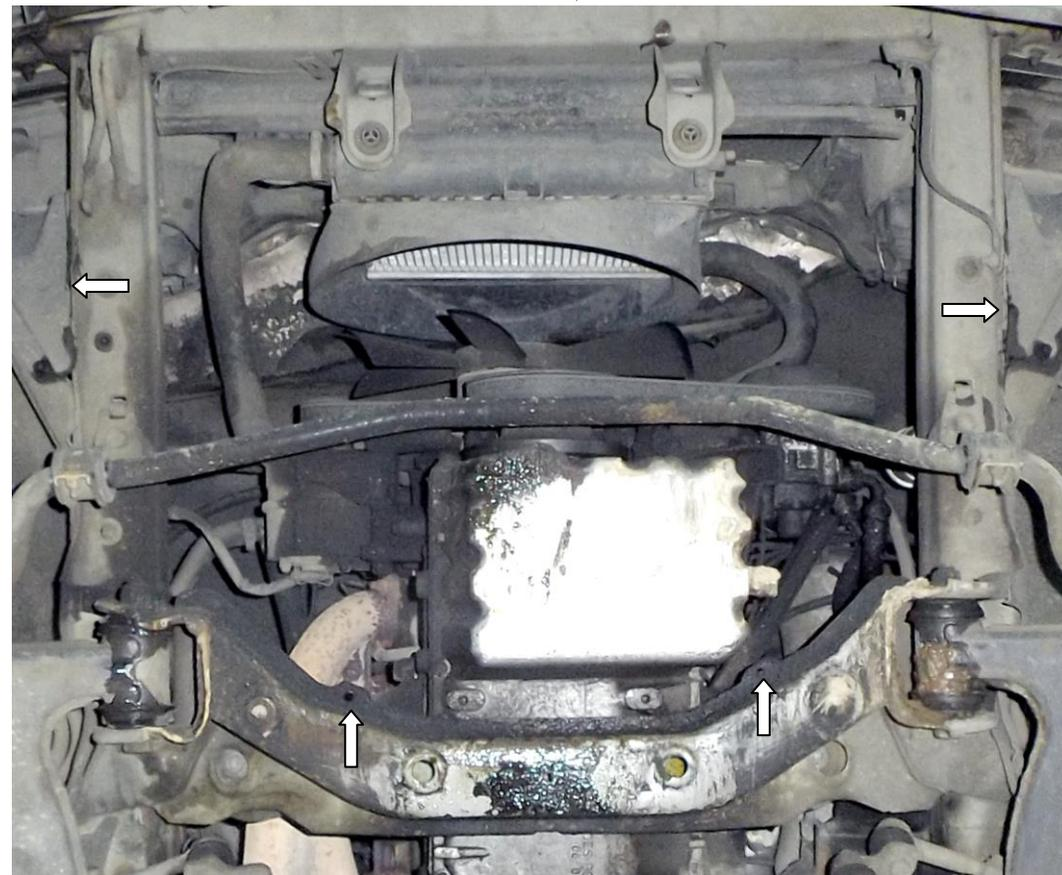
1. Установить балку 2 в отверстия лонжеронов указанных на рисунке.
